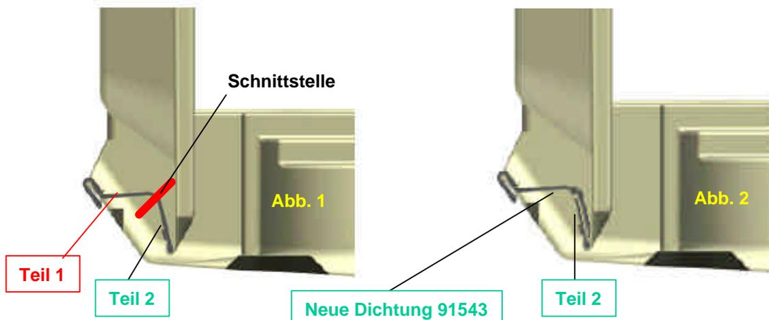
Die **ALTE** Dichtung ist in der kompletten Länge an der rot markierten Stelle zu schneiden
